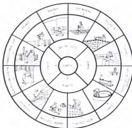
Figura 33 - Diagrama de Auroville, segundo o estado em que a terra é utilizada
