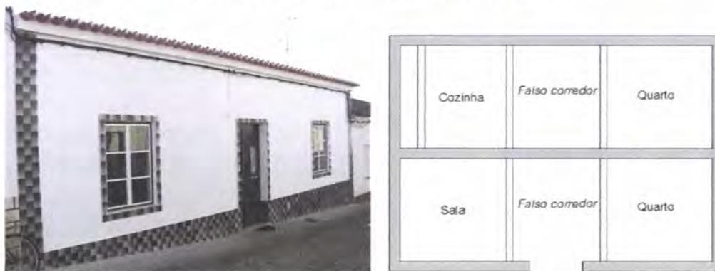
Figura 163 - 1 e 2; Casa de falso corredor, rua do Nova do Olival, nº 9, casa Tipo 6 e planta esquemática
