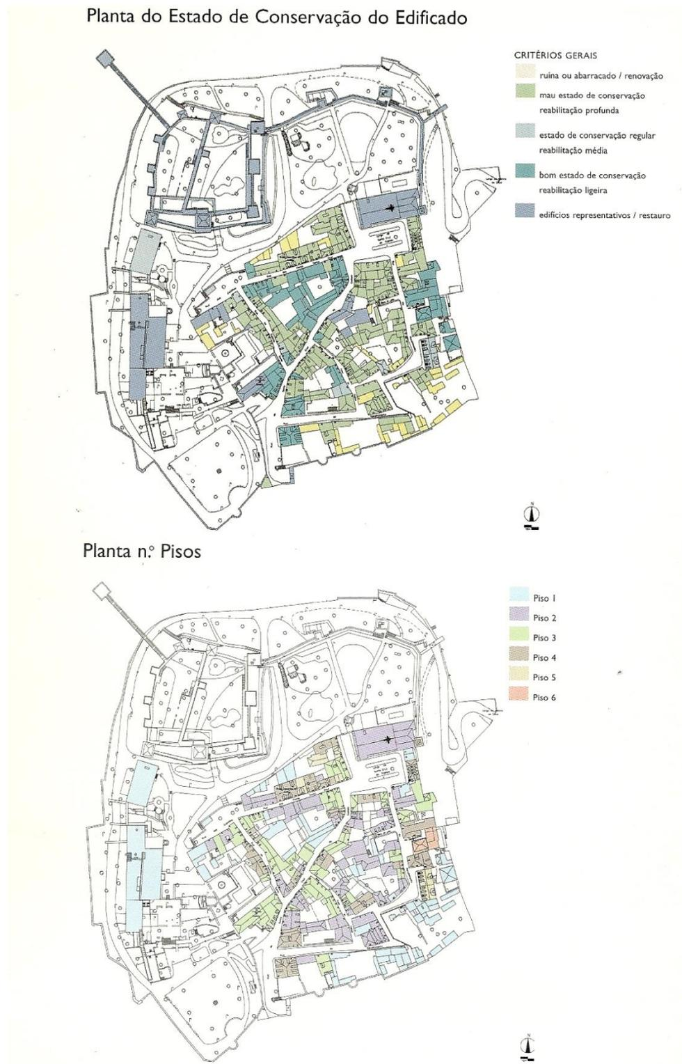
Fig. 133 - Planta do Estado de Conservação do Edificado (CML, 1995, p.5).
