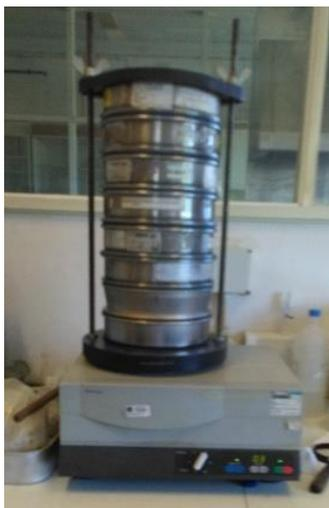
Figura 4.20 Agitador de peneiros para a separação granulométrica
