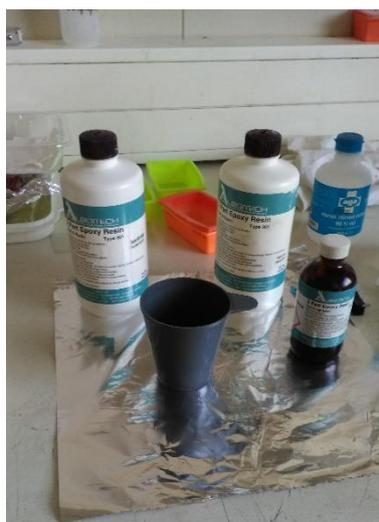
Figura 4.8 – Componentes para preparação da resina epóxi para a impregnação das amostras
