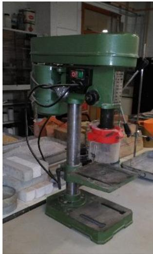
Figura 4.24 Equipamento de resistência à abrasão
