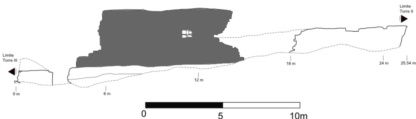
Figura 104 – Alçado do troço de muralha 3 com o modo construtivo (a cinzento).
