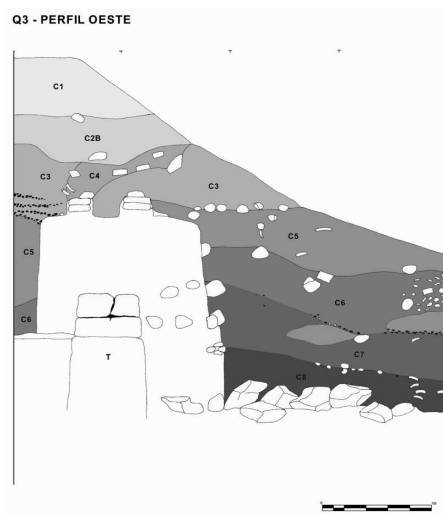
FIGURA 3. Perfil estratigráfico registando as três fases de ocupação: C1 e C2, sub-actuais; C3 e C4, 3ª fase, incluindo forno circular; C5 e C6, 2ª fase, incluindo muro de compartimento; C7 e C8, 1ª fase, incluindo colapso de muro (lev. SS e AT).
