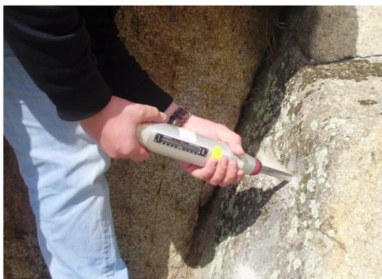
Figura 4.52 - Utilização do Martelo (esclerómetro de Schmidt) “*in situ*” para determinar o valor da dureza Schmidt (R) no setor Oeste.
