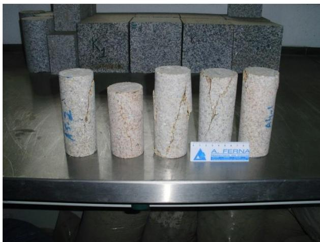
Figura 4.53 - Rotura dos corpos de prova após ensaio de resistência à compressão uniaxial.
