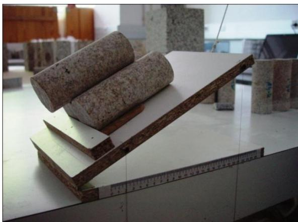
Figura 4.60 - Ensaio *tilt test* realizado em laboratório com equipamento construído pelo autor.
