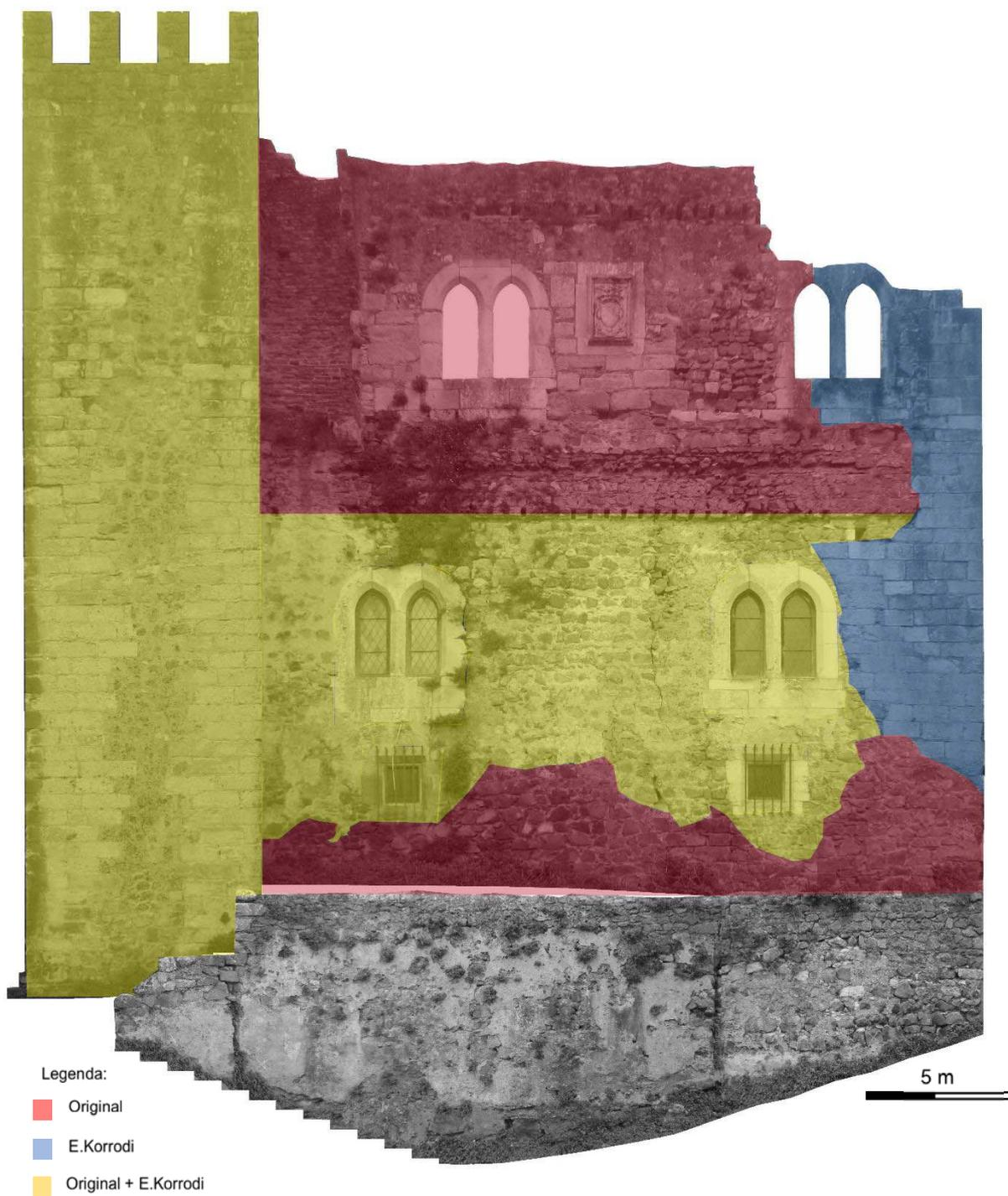
Figura 9.42 – Levantamento das intervenções realizadas no Alçado Norte.
