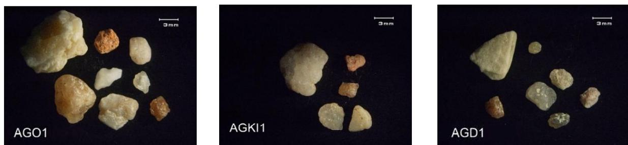
Figura 5.10 - Imagens à lupa binocular dos agregados presentes nas amostras AGO1, AGKI1 e AGD1, após realização de ataque químico com HCl.
