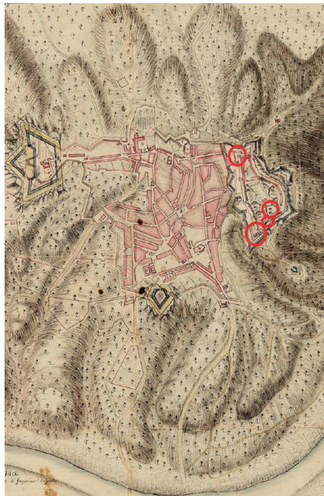
Fig. 25 | Mapa de Abrantes de 1731. Os círculos assinalam a campanha de obras seiscentista: os dois baluartes, a muralha sul (onde se encontra aberta a dita “Porta da Traição”) e os dois paióis e o muro que os rodeia.
