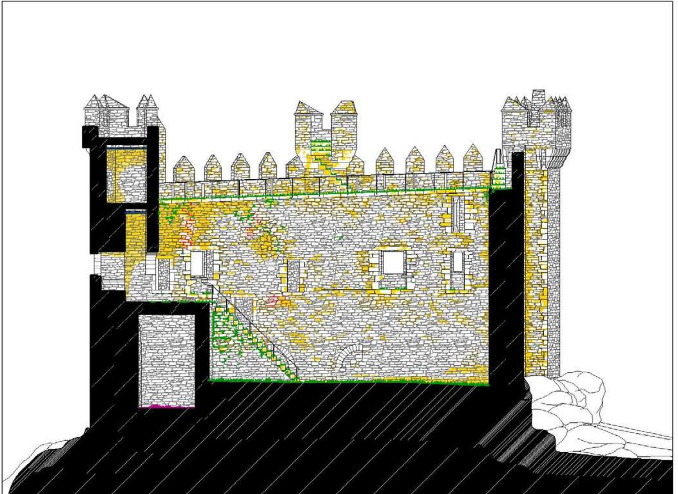
Fig. 71 - Mapeamento de danos na fachada interior nordeste do castelo de Penedono
